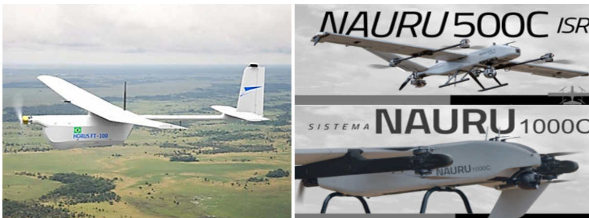
Figura 3 - Drones modelo FT-100 Horus e Nauru 500C/1000C.
